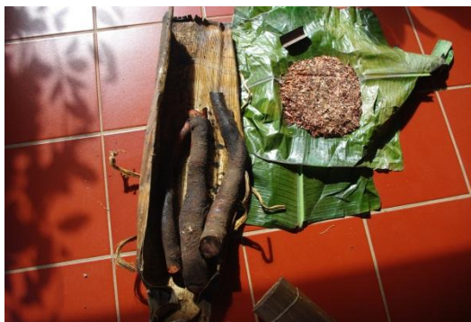
写真 31 : 板接合部充填用のマイハダ (同左)
