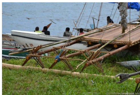
写真 22 : 籐で結縛されたミルンベイ型カヌー(同左)
