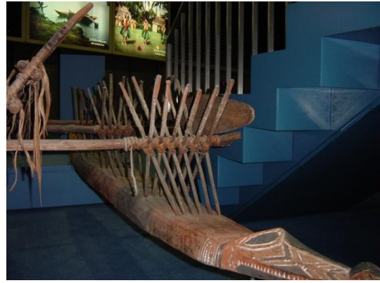
写真 14 : 籐によるショーテン諸島カヌー アウトリガーの結縛 (海洋文化館; 2009 年 9 月)
