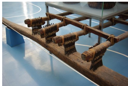
写真 16 : 籐によるマヌス型カヌーア ウトリガーの結縛(ブレーメン海外博物 館 ; 2010 年 8 月)
