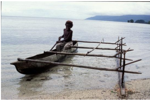
写真3：間接結合法のシングル・アウトリガー式カヌー：PNG ビスマルク諸島ニューアイルランド島 (2003年9月)
