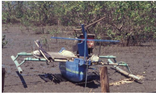
写真4：間接結合法のダブル・アウトリガー式カヌー：インドネシア・スラウェシ島・ウジュンパンダン付近(1994年8月)
