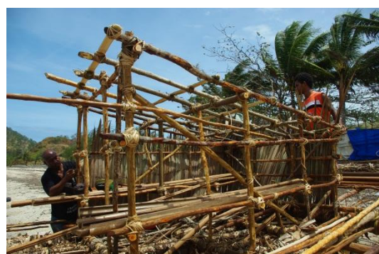
写真 18 : 籐によるラカトイの部材の結縛: PNG 国ポートモレスビー付近独立記念日 祝祭用のラカトイ型カヌー (2011 年 9 月)
