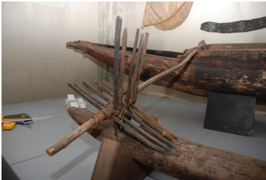
写真 15 : 籐によるショーテン諸島カヌー アウトリガーの結縛(南山大学人類学博物 館 ; 2010 年 9 月)
