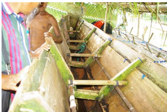
写真 30 : クラカヌーの内部構造 (キリウィナ島; 2011 年 9 月)
