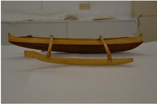
写真1：直接結縛法のシングル・アウトリガー式カヌー模型 (ホノルル・ビショップ博物館; 2012年9月)
