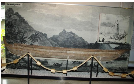
写真 34 : 縫合型のツアモツ式カヌー (タヒチ国立博物館、2010 年 8 月)
