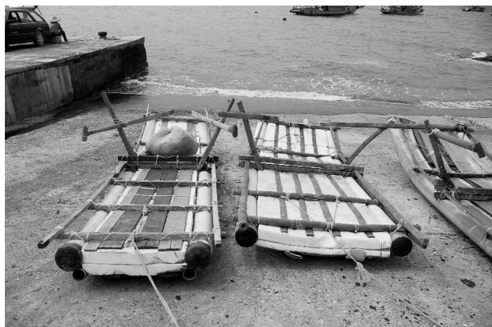
図5-6 台湾東海岸で使用される塩ビパイプを発泡スチロールで補強した筏式漁船
