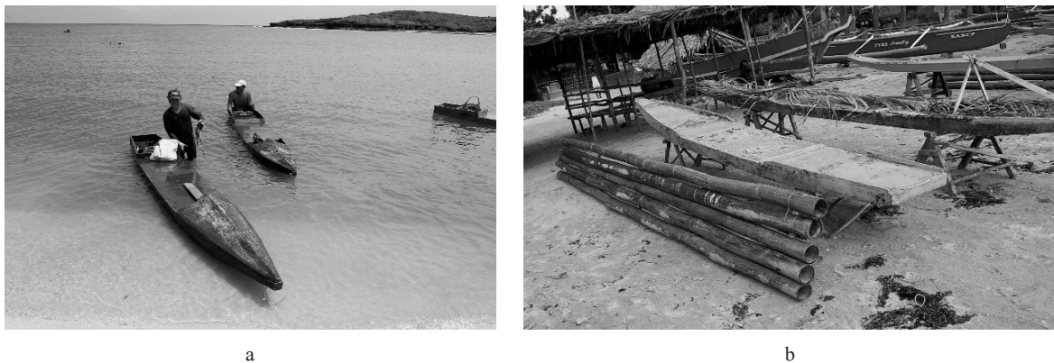
図5-35 イロコス海岸で使われる筏改良型の平底船バラシャン a: バラシャンでの漁 b: バンカ舟および竹筏と共存するバラシャン
