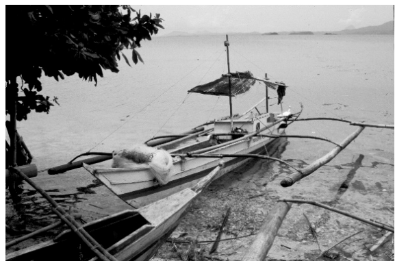
図7-2 直接結縛法のダブル・アウトリガー式カヌー: フィリピン・パナイ島イロコス海岸
