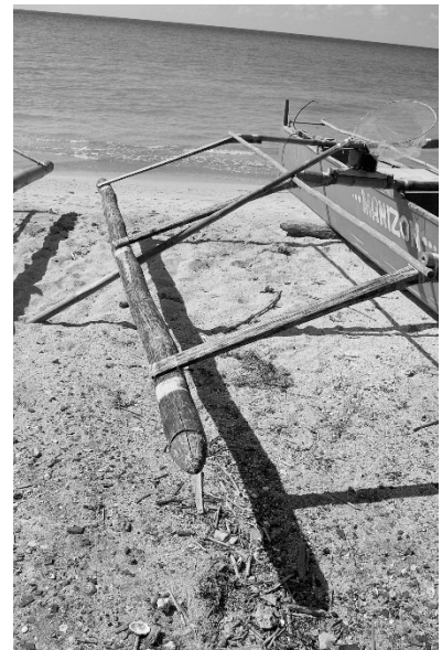
図7-9 中間材の入ったダブル・アウトリガー式カヌーの浮き木部分：イロコス海岸
