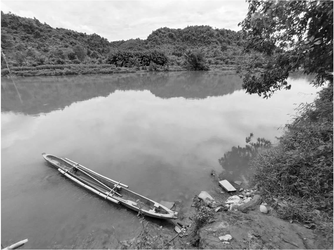
図7-8 舷側の両側に竹の張り出しをもつスラウェシ島の川舟（門田修氏提供：撮影 Muhammad Ridwan Alimuddin 氏）
