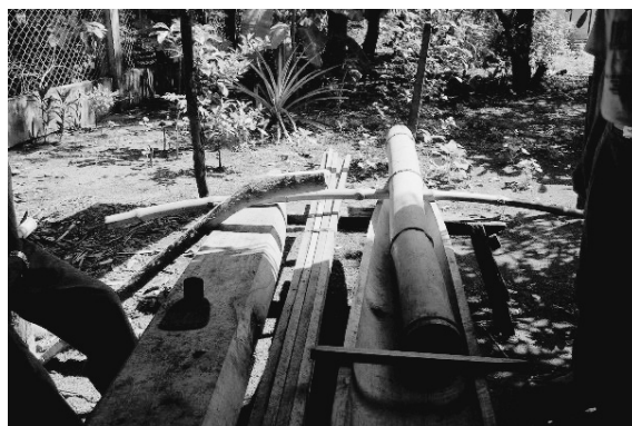
図11-5 湾曲する竹製の腕木、肘型の装着材とマダケの浮き木 (Padugpud)
