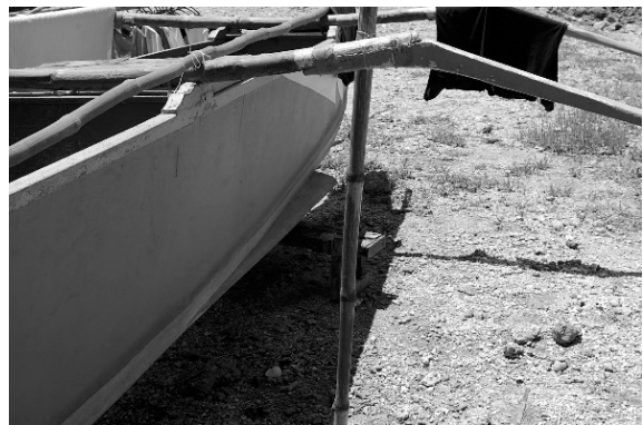
図11-8 フィン付き合板船体のバンカ (Cabugao)
