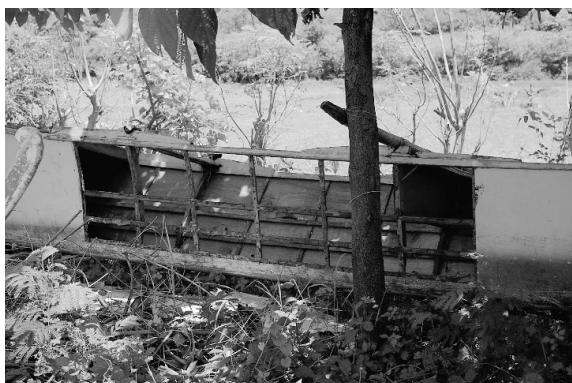
図11-4 バンカの合板製船体の骨組み (Davila)
