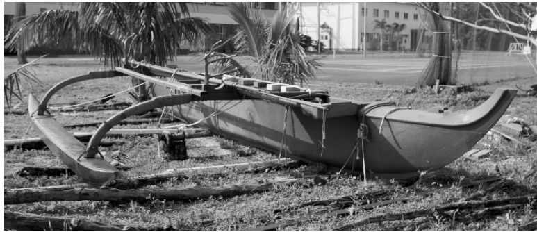
図12-11 現在使用されているファイバーグラス製の船外機用カヌー（父島にて） 船尾に帆を張るためのロープを縛る突起の残存が残る。モデルは浅沼精太郎 氏が戦後千葉で作って「輸出」した図12-10のようなカヌー
