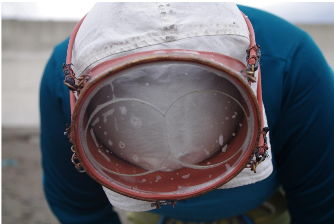
写真4 老眼仕様の潜水メガネ（三重県志摩市安乗 2013年8月撮影）
