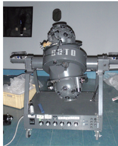
写真2 五藤光学製のアナログ式投影機。内部から光源で星を投影する。手前のつまみを回して場所（赤緯）や時間（赤経）、あるいは明るさなどを調節する。
